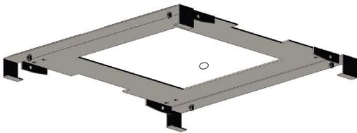
2. Kabinendecke schachtseitig um die Befestigungslöcher entfetten. Schutzfolie von den Klebestreifen der Schraubenpads abziehen, Schrauben durch die Löcher stecken und gleichzeitig die Schraubenplatte ankleben.
