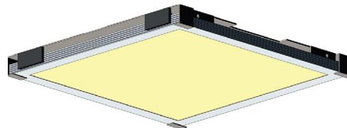
8. Abdeckung aufsetzen und mit beigelegtem Imbuschlüssel und vier Madenschrauben befestigen.
