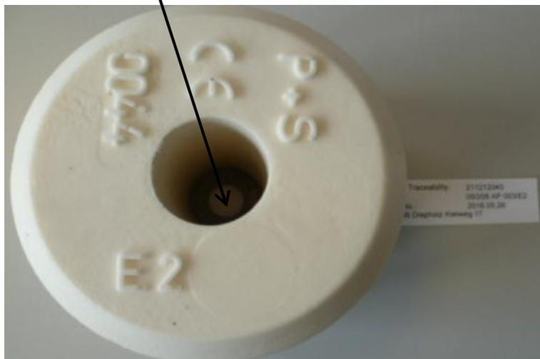
Kennzeichnung entspricht der Richtlinie 2014/33/EU und wurde Ordnungsgemäß angebracht.
