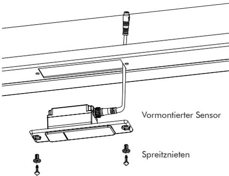
**Abb. 8:** Hinterwandmontage (zentral öffnende Türen)
