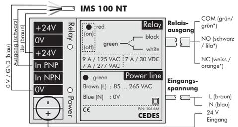
**Abb. 29:** Anschluss Schaltnetzteil von CEDES (Art. Nr. 106 666 / 111 014\*)
