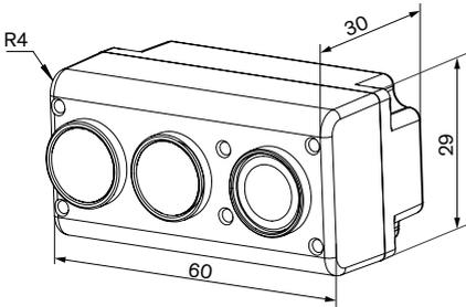
IMS 100 NT Sensorgehäuse / IMS 100 NT sensor body
