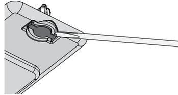
**Abb. 25:** Lösen der Spreitznieten
