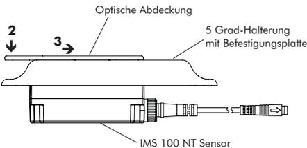
**Abb. 24:** Optische Abdeckung - drücken (2) und schieben (3)
