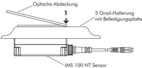
**Abb. 23:** Positionierung der optischen Abdeckung (vorsichtige Handhabung)
